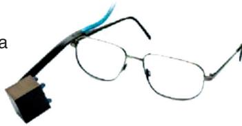
Celý systém je primárně určen k simulaci ovládání kurzoru polohovacího zařízení. Nelze vytvořit systém, který by umožňoval způsob ovládání typu „kam se dívám, tam bude kurzor“. Systém pracuje na principu zachycení pohybů oka nějakým směrem z klidové zóny, který se promítne do pohybu kurzoru.
